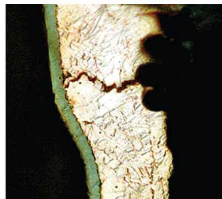
Рис. 3. Разрыв стенки металлизированного отверстия в результате чрезмерного температурного расширения диэлектрика
