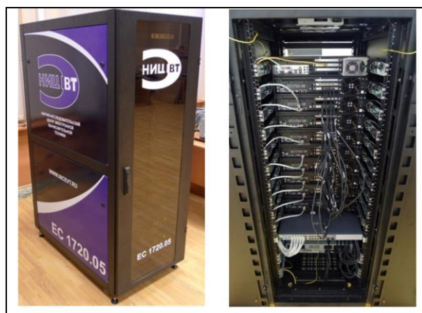
Рис. 3. Вычислительный кластер EC1720.05, оснащенный макетными образцами маршрутизаторов межузловой коммуникационной сети EC8430 «Ангара», представленный на ChipExpo-2010 (Москва)
