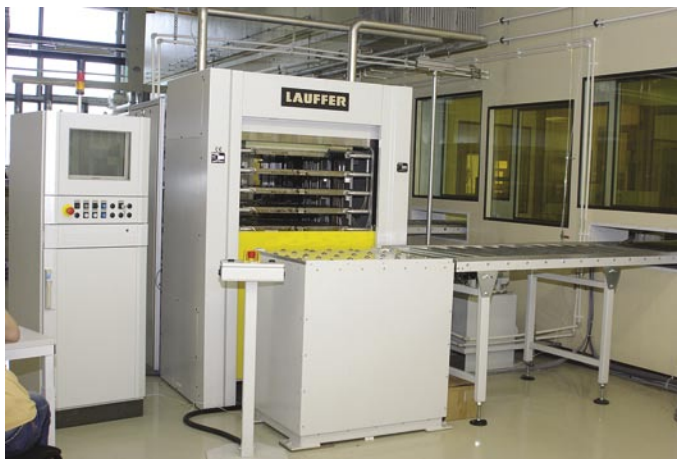
Рис. 4. Гидравлический пресс с вакуумной камерой и масляным обогревом плит
