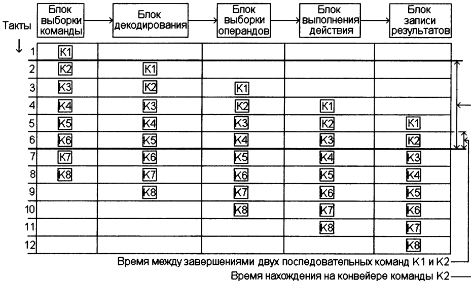
Рис. 11.3. Пятиступенчатый конвейер выполнения команды
