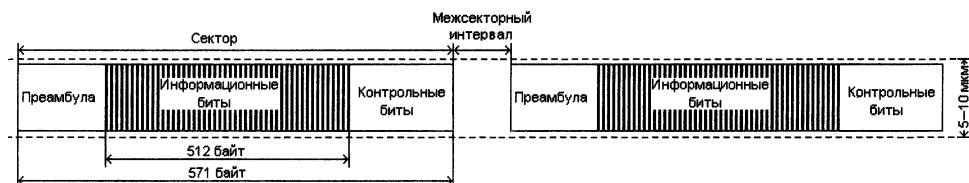
Рис. 12.2. Структура стандартной дорожки магнитного диска
