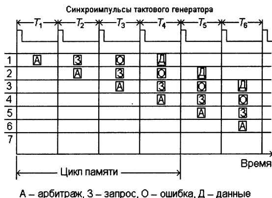
Рис. 10.3. Упрощенная схема конвейерного режима шины
