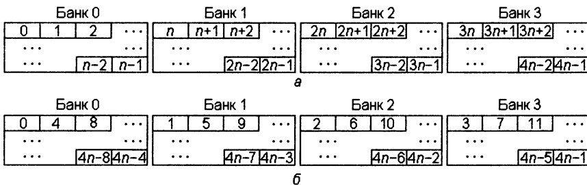
Рис. 7.6. Адреса в банках: а — последовательное распределение; б — чередование
