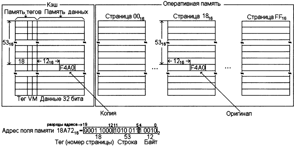
Рис. 9.2. Кэш прямого отображения
