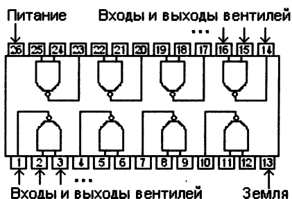
Рис. 3.19. Пример простейшей интегральной схемы, состоящей из восьми вентиляей «НЕ И»
