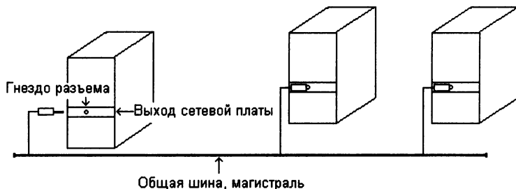
Рис. 21.1. Упрощенная схема подключения компьютеров к локальной сети
