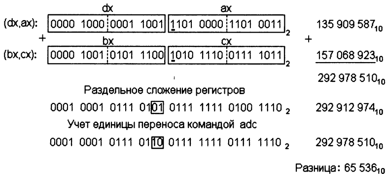
Рис. 4.34. Многоразрядное сложение с применением команды adc
