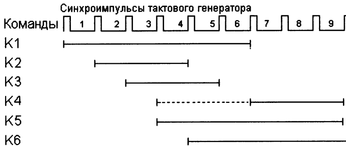
Рис. 11.8. Выполнение команд с переупорядочением
