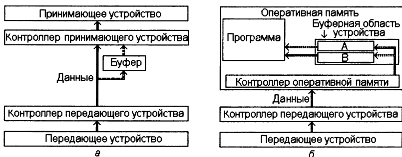
Рис. 5.8. Схема использования: а — буфера; б — буферных областей памяти
