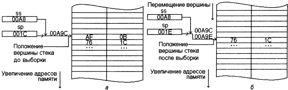
Рис. 4.31. Схема выполнения команды выборки из стека pop
