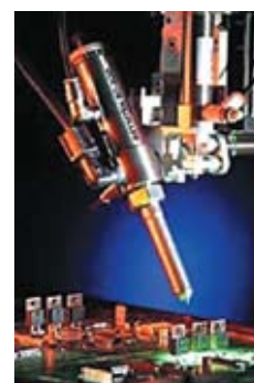
Рис. 2. Модуль SC-300 “Swirl coater”
